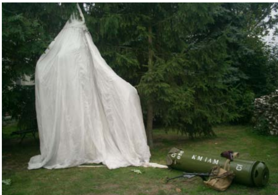
Ryc. 60. Brytyjski kontener zrzutowy C.L.E Mk. III służący do transportu 2 lkm. „Bren” wraz z zapasem amunicji
